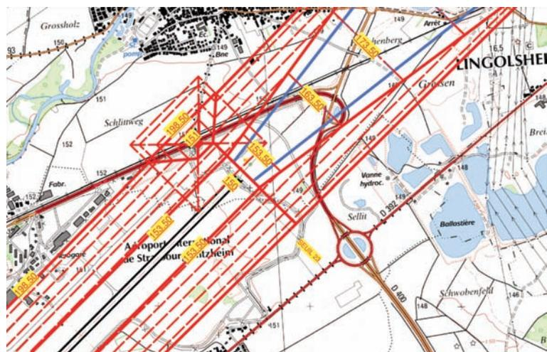
Figure 32 : Représentation des cotes altimétriques au niveau des surfaces latérales
